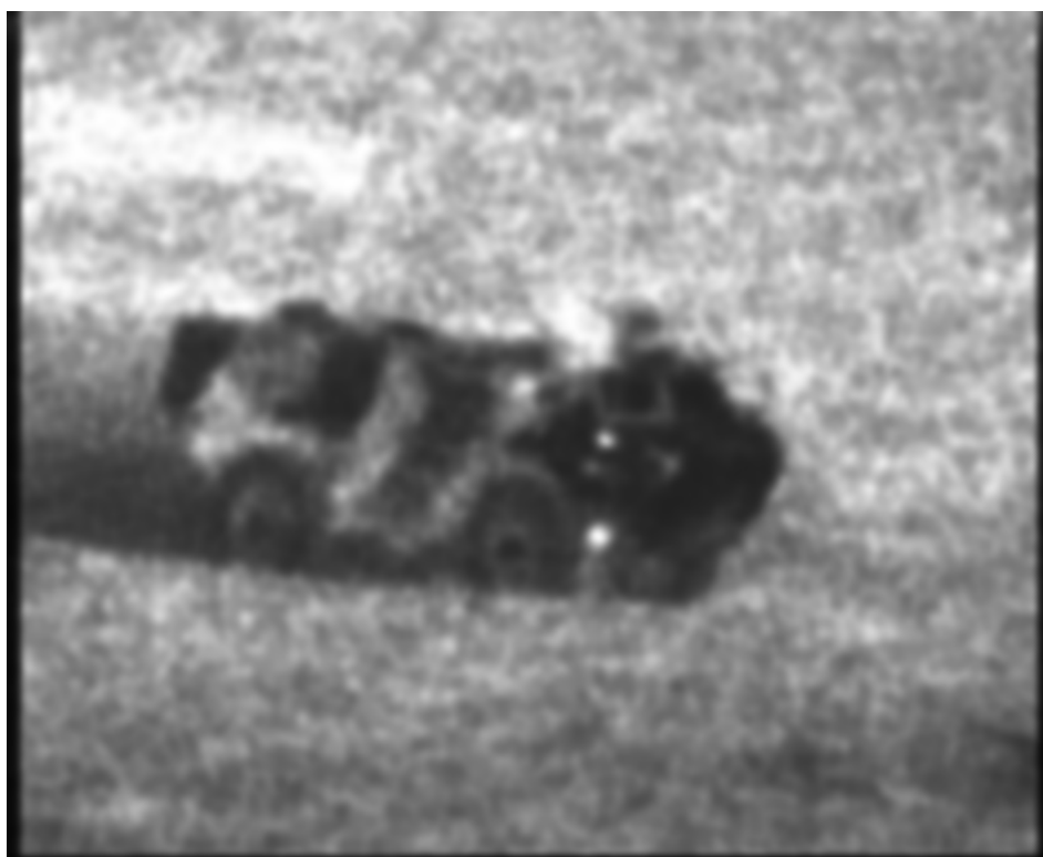
FIG. 4.8 – Image active laser blindé débruitée ( \mu = 100 , \lambda = 1 , 50 itérations).
