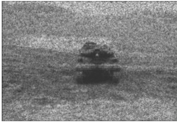
FIG. 5 – Exemple d'image acquise en imagerie active laser.
