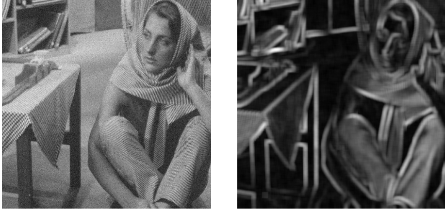
FIG. 3.2 – Exemple de fonction de pondération \nu (à gauche l'image initiale bruitée, à droite la fonction de pondération correspondante)
