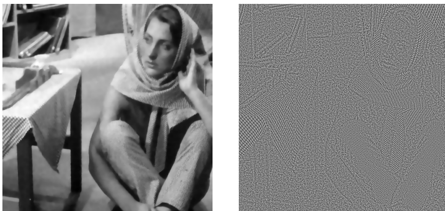
FIG. 3.1 – Composantes obtenues sur une image bruitée par un modèle u, v .
